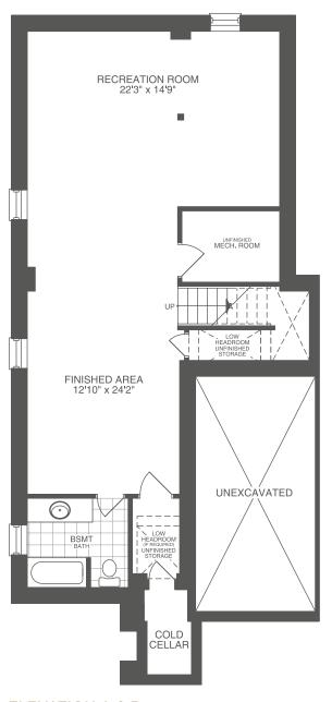
ELEVATION A & B OPT. FINISHED BASEMENT
